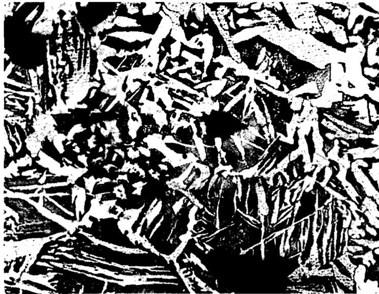
18 Structure Widmannstätten du fragment d'acier à teneur moyenne en carbone enfermé dans la scorie (n° 7): ferrite (pâle) dans l'espace intergranulaire et à l'intérieur des grains, dans une matrice de perlite (foncée). Échantillon traité avec une solution composée de 4 pour cent de nital. (x85)
