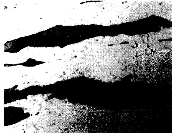
35 Structure à deux éléments des inclusions de scories dans le fragment de fer forgé (9M): mélange de FeO et de SiO<sub>2</sub>. Échantillon poli (non traité à l'acide). (x320)
