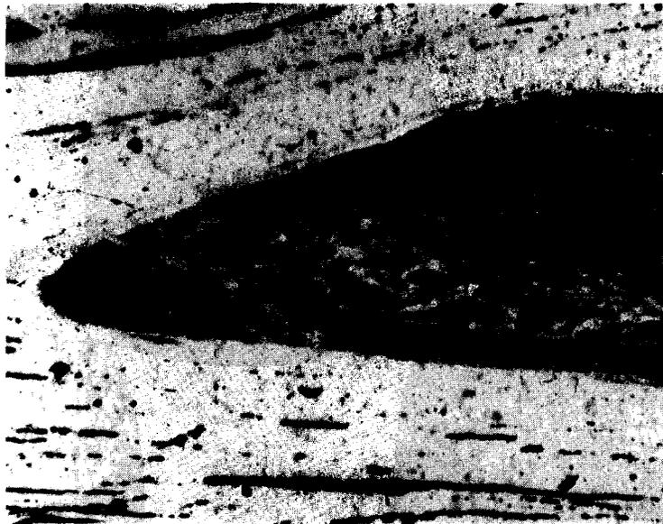
27 Taillant en acier (foncé) soudé par forgeage à la lame en fer forgé (pâle) dans le fer de hache 1H51G3-9. Échantillon traité avec une solution composée de 4 pour cent de nital. (x21,25)
