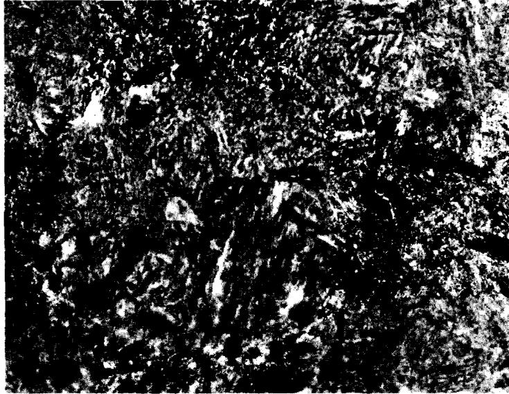
26 Structure du taillant en acier trempé (refroidissement rapide). Bainite supérieure (nervurée). Échantillon traité avec une solution composée de 4 pour cent de nital. (x850)
