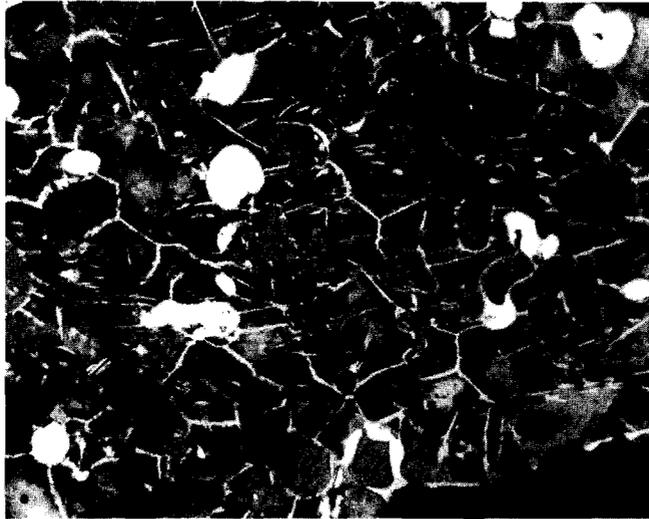
**27** Structure du fragment de fonte enfermé dans la scorie (n° 8): élément pâle dans l'espace intergranulaire et à l'intérieur des grains de perlite (foncée) ainsi qu'un grand nombre de particules de cuivre (blanc). Échantillon traité avec une solution composée de 4 pour cent de nital. (x75)
