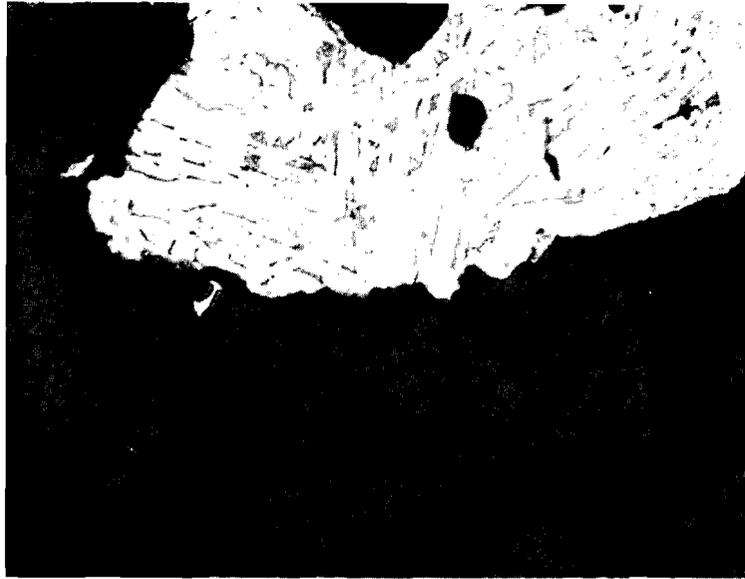
17 Structure du fragment d'acier à moyenne teneur en carbone emprisonné dans la scorie (n° 85): ferrite (pâle) et poches de perlite (foncée). Échantillon traité avec une solution composée de 4 pour cent de nital. (x85)
