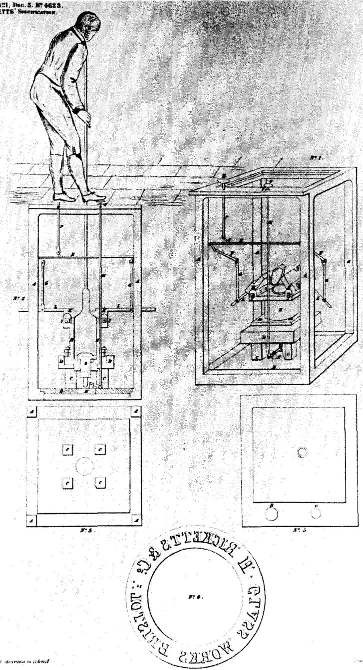
**Figure 63.** Les dessins qui accompagnent la spécification du brevet de Ricketts montrent les différentes parties du moule et ses mouvements fonctionnels (Grande-Bretagne. Patent Office, 1857. Photo: R. Chan; RD-869M).
