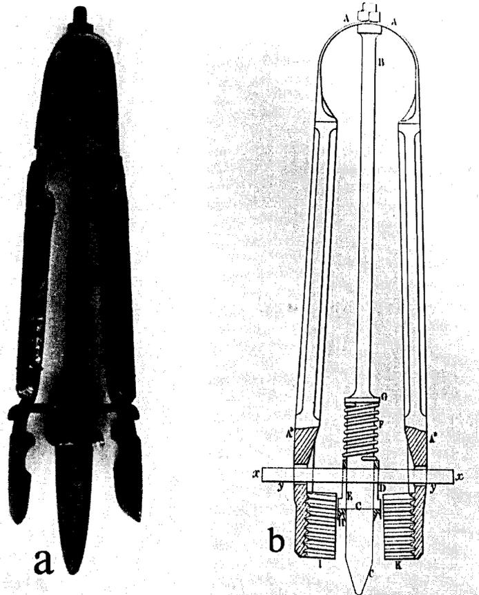
**Figure 12.** Il existait de nombreux types et différentes grandeurs de pinces de finition: (a) montre un type de pince relativement simple et (b) une pince permettant de façonner des lèvres filetées à sillons (Grande-Bretagne. Patent Office. 1844. Photos: O. Jones, R. Chan; RA-7315B, RD-882M).
