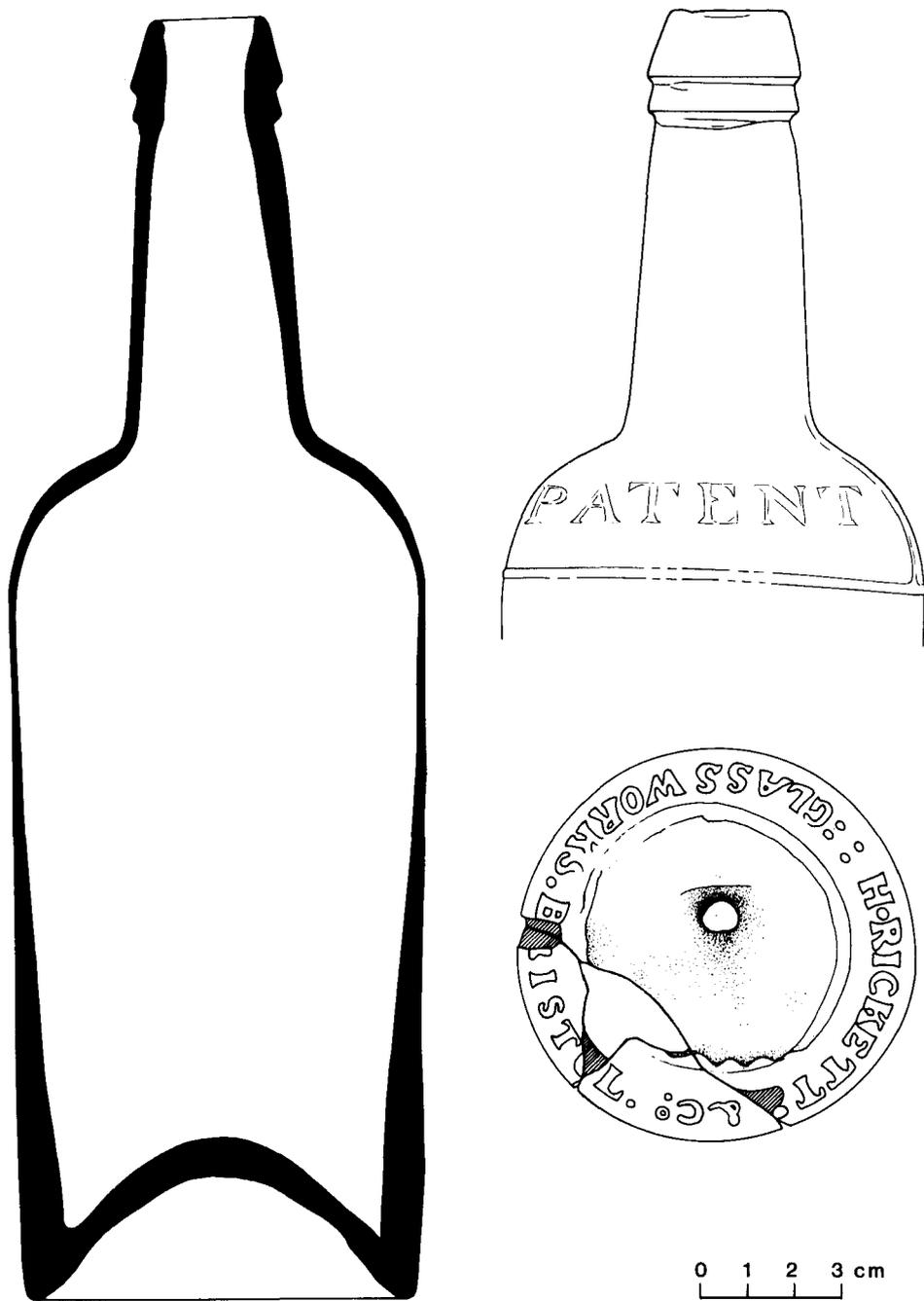
**Figure 62.** Soufflée au moule Ricketts, cette bouteille porte à la jonction du corps et de l'épaule les marques caractéristiques du moule "en trois parties". Elle porte aussi une inscription en relief sur le cul et sur l'épaule (dessins: D. Kappler).
